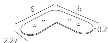
Коннектор угловой для накладного и встраиваемого магнитного шинопровода. Используется для механического соединения треков.
