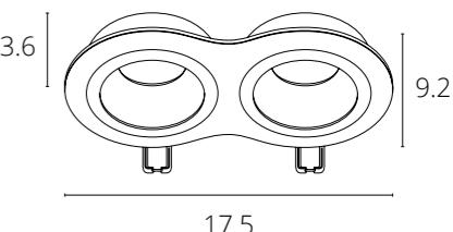
Высота светильника с модулем 6 см.
