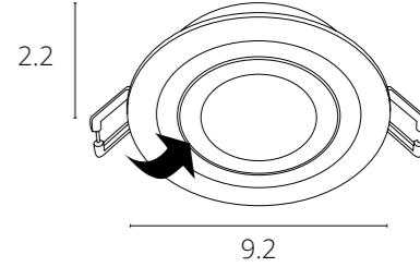
Высота светильника с модулем 3,4 см.
