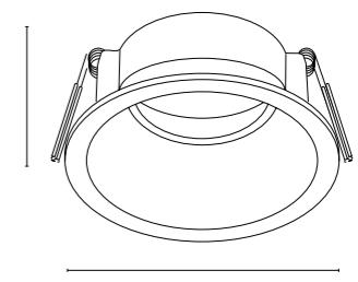
Высота светильника с модулем 5,8 см.
