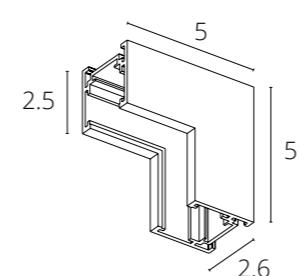
Коннектор угловой внутренний для накладного магнитного шинопровода
