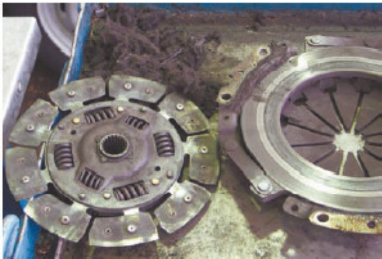
Рис. 4.3. Изношенные диск и корзина сцепления
