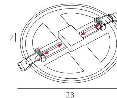
Крепления регулируются под монтажное отверстие Ø 5-21
