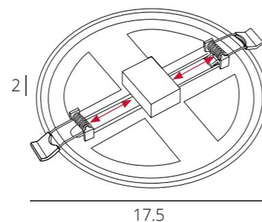
Крепления регулируются под монтажное отверстие Ø 5-16
