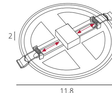
Крепления регулируются под монтажное отверстие
