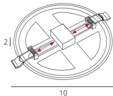
Крепления регулируются под монтажное отверстие
