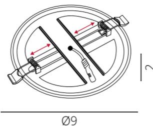
Крепления регулируются под монтажное отверстие
