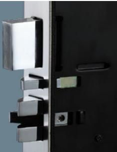
Маленькая защелка нажата при закрытой двери, предотвращает открытие двери отжимом основной защелки (например, ножом). Трехточечная основная защелка обеспечивает мягкое закрытие двери
