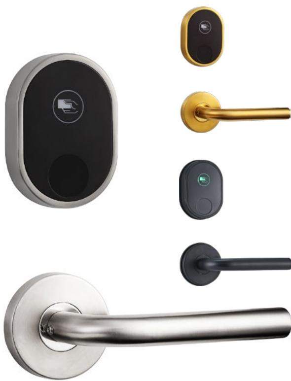
Электронный RFID Mifare замок, раздельные накладки которого выполнены из нержавеющей стали марки AISI 304, а электронные компоненты защищены компаундом. Замок комплектуется резиновыми герметичными прокладками под ручку и считыватель. Это позволяет устанавливать замок в условиях повышенной влажности
