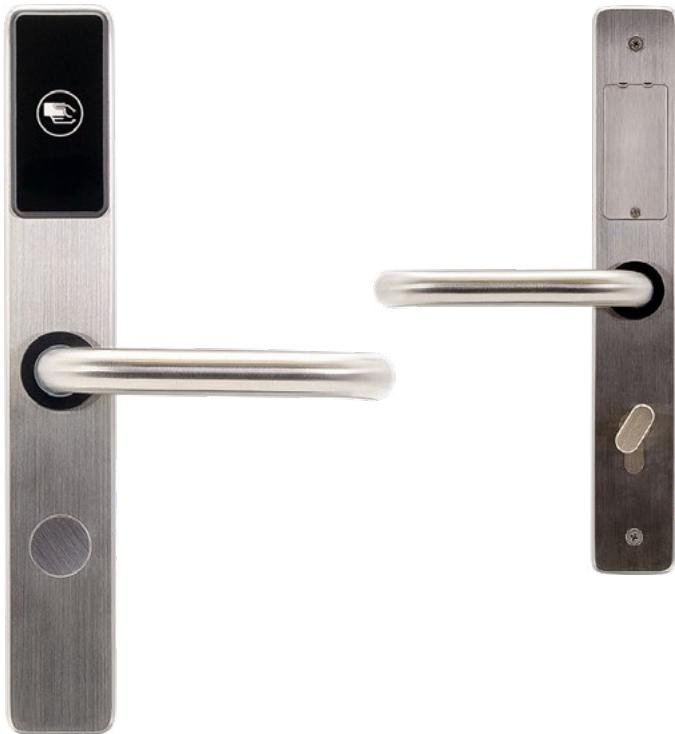
Электронный RFID Mifare замок, электромеханические компоненты которого перенесены в накладки. Во врезной части используется стандартный Евроцилиндр (DIN), расстояние между центром цилиндра и центром ручки 72 или 85 мм. Идеальное решение для замены старых механических замков без модификации двери
